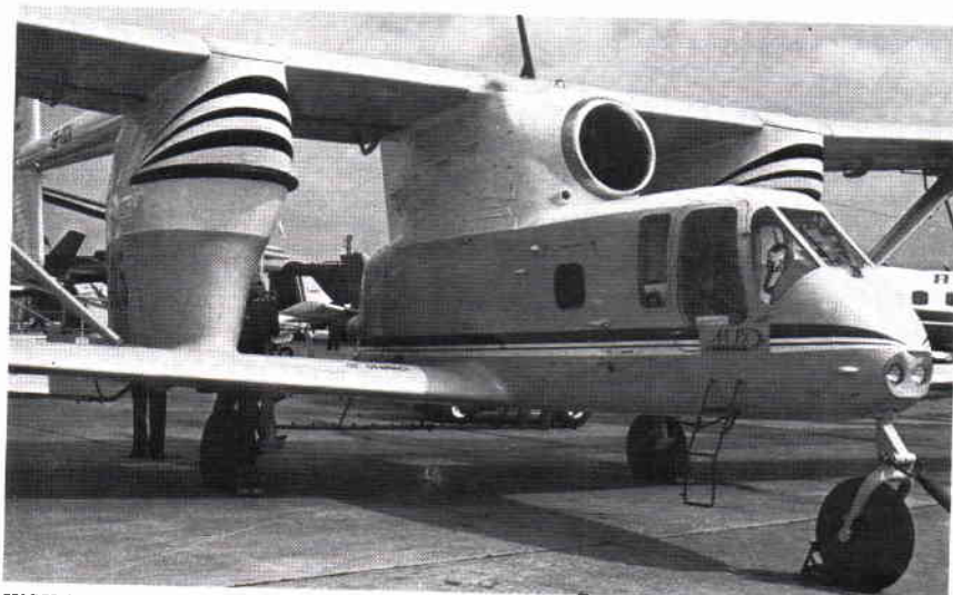
WSK-Mielec M 15, världens första jetdrivna biplan för bepudring. Polsk-Sovjetisk Konstr. Obs vingstöttorna är behållare för spridningsmedel.
