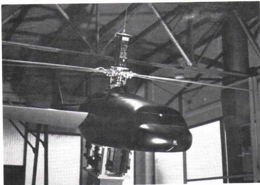
DFVLR: a avancerade provbock för helikopterutprovning.
