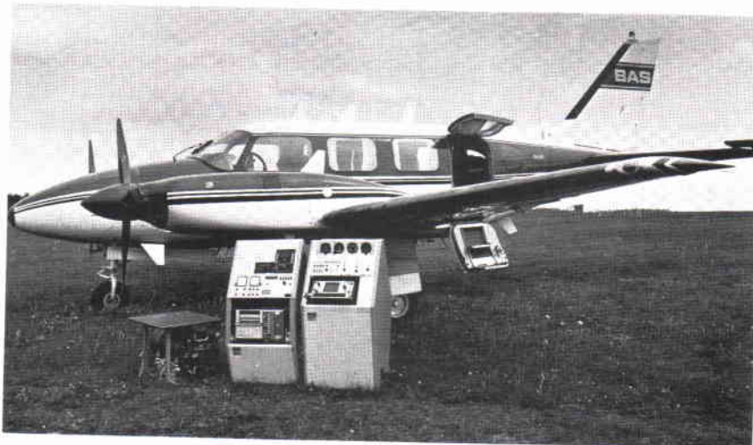
Två mätbord och nav-radar PN 59 sköts under kontrollflygningarna av personal från FFV-U i denna Piper Navajo från BAS i Västerås.
