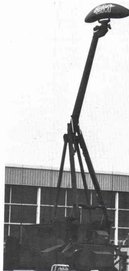
"LME-Giraffe" = rörlig spaningsradar med pulserande doppler.
