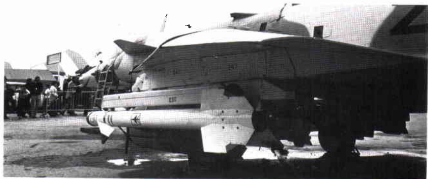
Vingnedsvep eller "camber". Ger bra lågfartsegenskaper. Vingen är f ö avsevärt mera utvecklad än förebildens MIRAGE 3. Under vingen sitter f ö en Shafir robot (liknar "Sidewindern").
