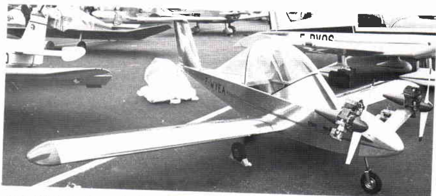
CRICRI Lätt flygplan med 2 McCulloch gräsklipparmotorer. Vingarna av aluminiumplåt över hård skumplast.
