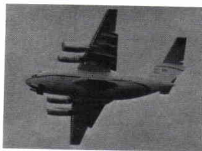
McDonnell Douglas YC-15. Obs att yttersta babordsmotorn är den större provmotorn SNECMA/GE CFM-56.
